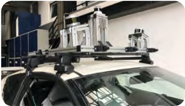
10. ábra: A mérőjármű tetőcsomagtartójára szerelt érzékelői
